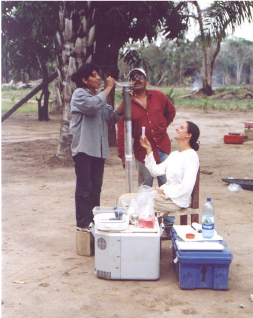
Figura 3 : Extracción del muestreo de sedimento de la Laguna Granja (Water-Mark sediment sampler).
