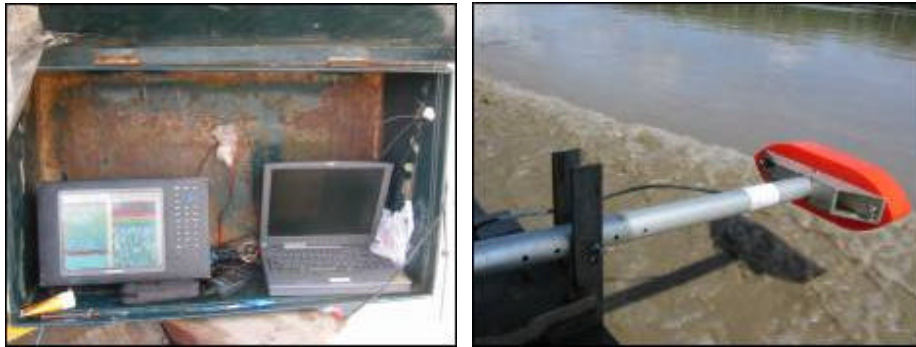
Dispositivo de medida de batimetría: el monitor y la ecosonda.
