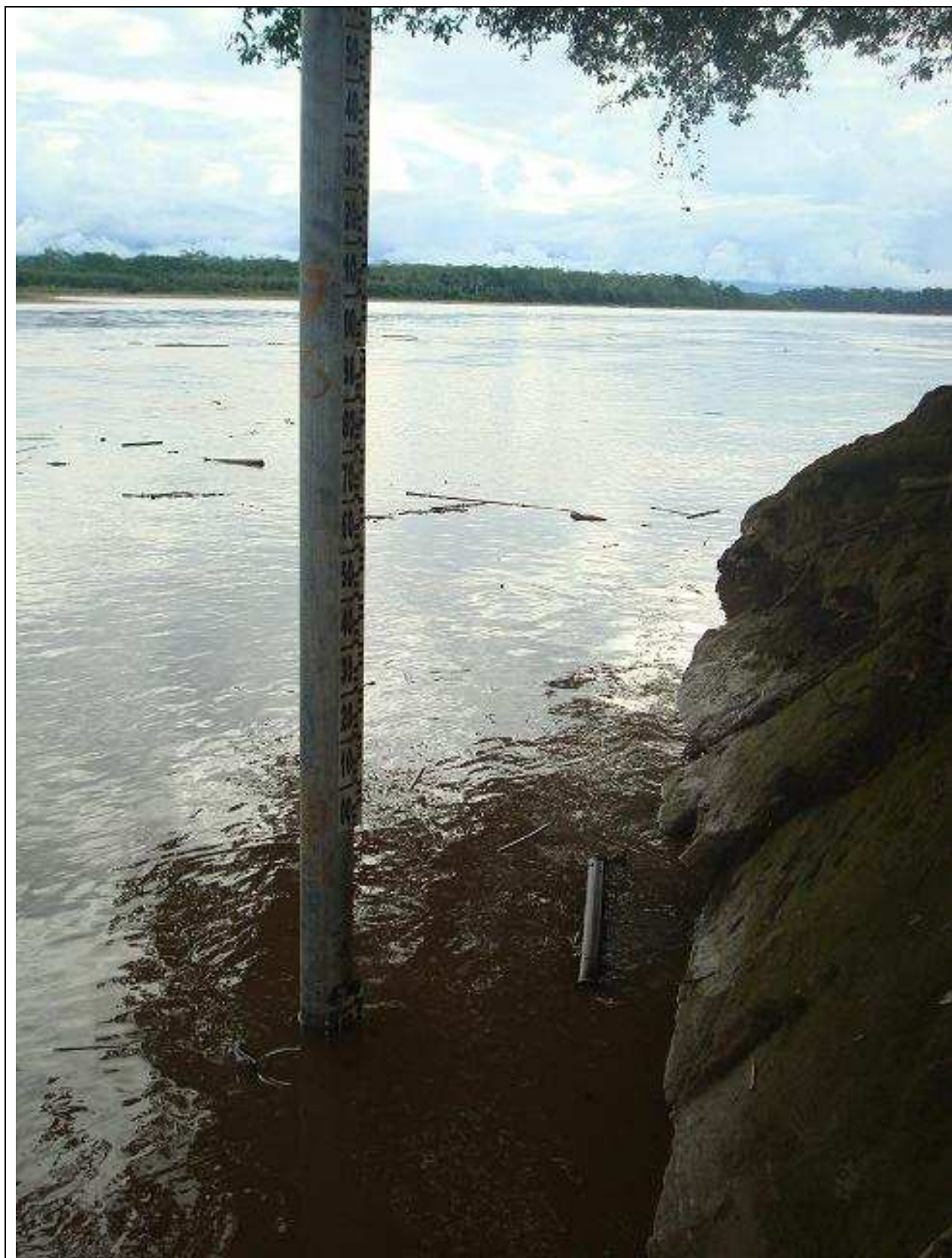
Escala de Lagarto de 500 a 900 (tubo galvanizado)
