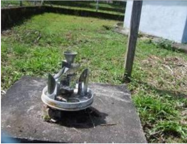
Foto 7. Interior del pluviómetro de la meteorológica Borja totalmente expuesto a la intemperie.
