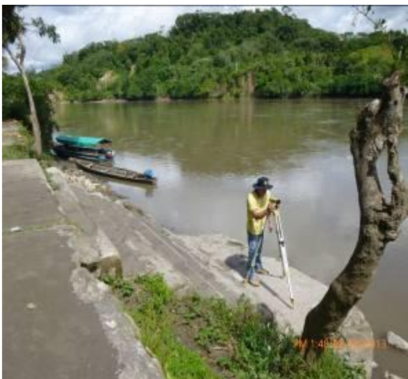
Foto 5. Nivelación de la regla Limnimétrica de la estación Borja
