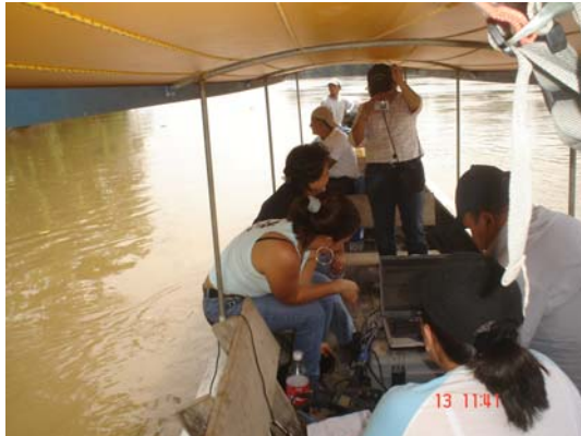
Fotos 7 y 8. Aforos y batimetrías realizado sobre el Río Coca.
