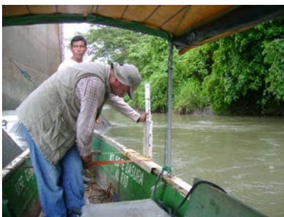
Foto: Instalación del ADCP para el aforo líquido
