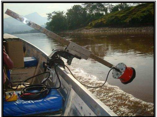
Foto N° 4: Aforando con ADCP FlowQuest del SENAMHI
