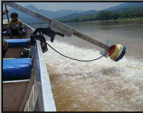
Foto N° 3: Aforando con ADCP RDI Workhorse del IRD
