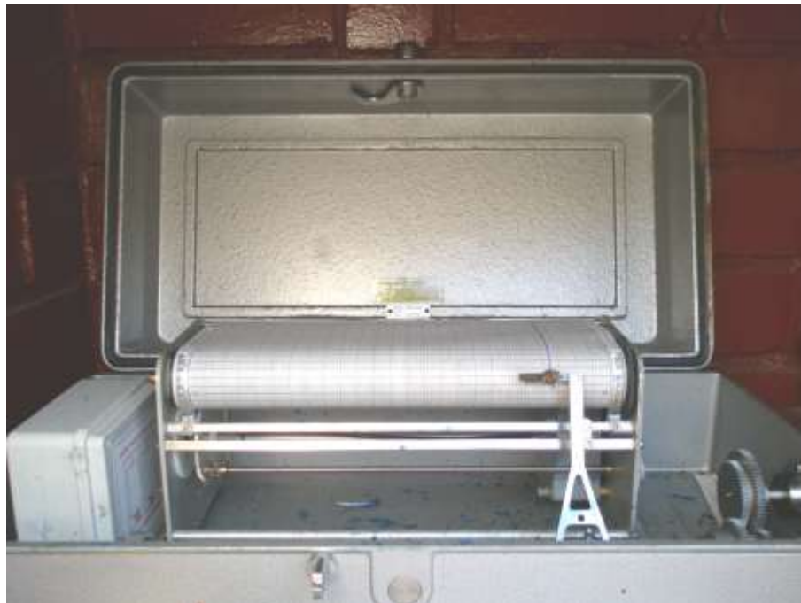
Fig 7. Limnógrafo de la estación Socsi en buen estado.
