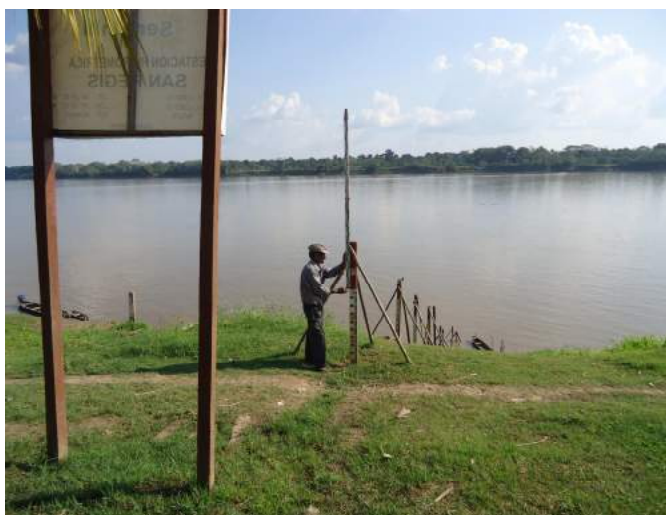
Foto N° 3: Nivelando reglas H. San Regis
