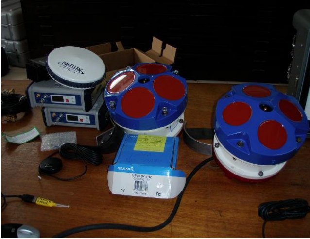
photo 6 : ADCP (600 & 1200 khz) & GPS du SCEVN
