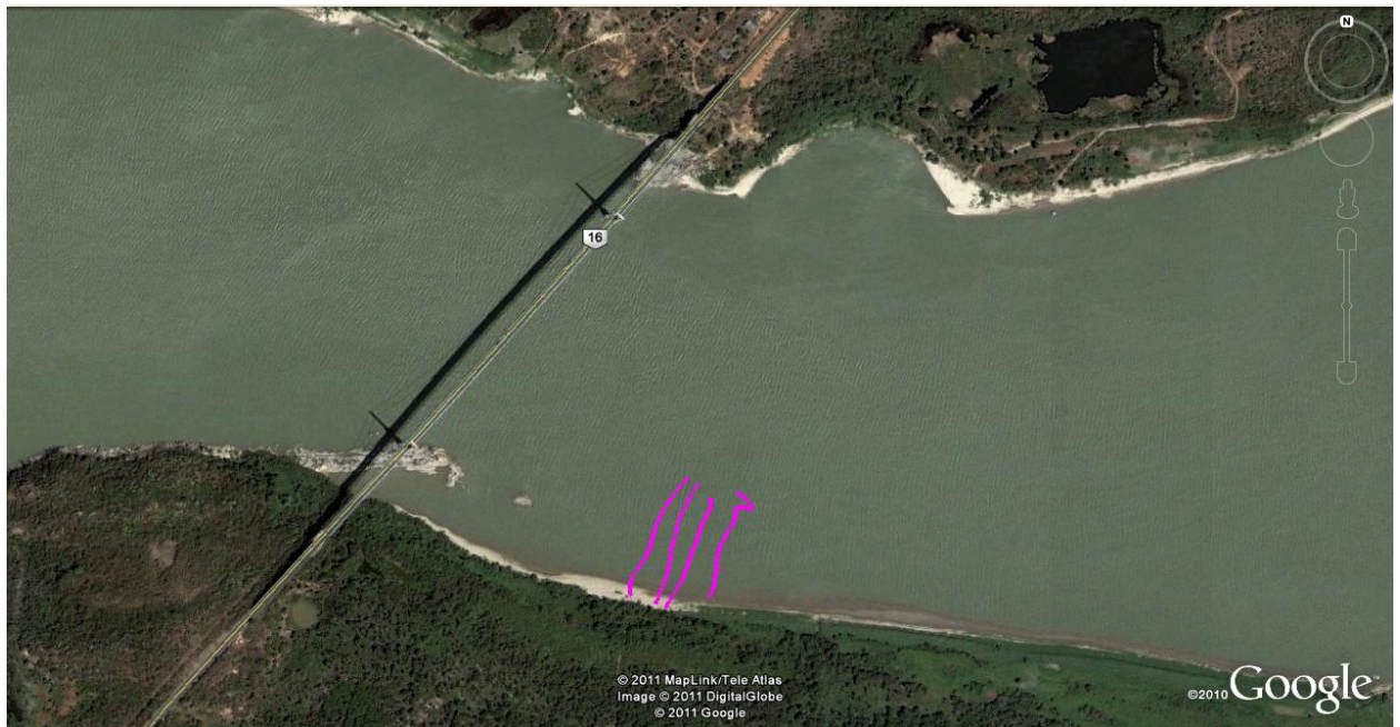
Figura 7: Líneas del levantamiento batimétrico en Puente Angostura Ciudad Bolívar (08/07/2011)
